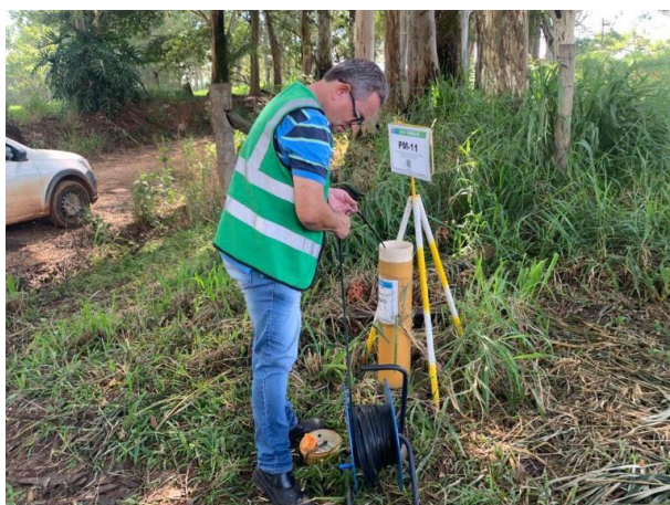
Foto 9 – Leitura de nível d'água no PM-BDP-03. (Data: 19/04/2023).
