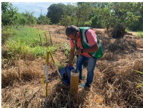
Foto 3 – Leitura de nível d'água no PM-BDP-03. (Data: 30/03/2023).
