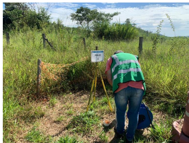
Foto 4 – Leitura de nível d'água no PM-BDP-08. (Data: 30/03/2023).
