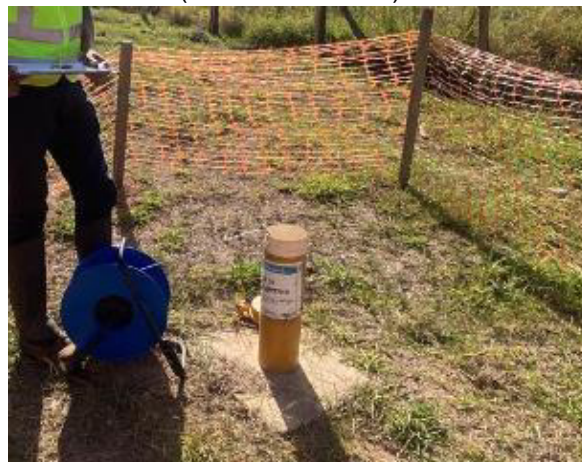
Foto 12 – Leitura de nível d'água no PM-BDP-07. (Data: 17/05/2023).
