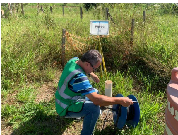
Foto 5 – Leitura de nível d'água no PM-BDP-03. (Data: 30/03/2023).
