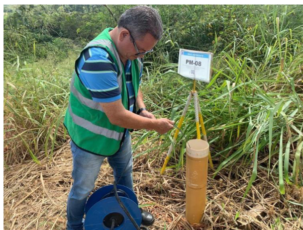
Foto 10 – Leitura de nível d'água no PM-BDP-08. (Data: 19/04/2023).
