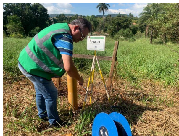
Foto 6 – Leitura de nível d'água no PM-BDP-08. (Data: 30/03/2023).
