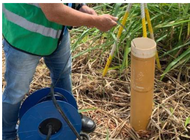
Foto 11 – Leitura de nível d'água no PM-BDP-03. (Data: 17/05/2023).
